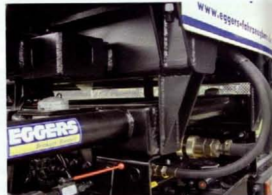
Schnellverschluss: Schnell lösbare Verbindung zwischen Pritschenhilfsrahmen und Krantragrahmen dank Containerverriegelungen
