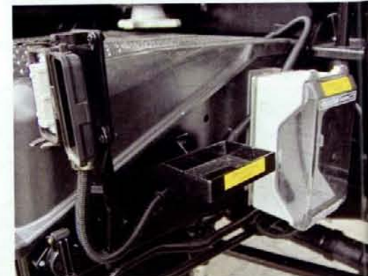
Halte-Stelle: Äußere Halterung und Anschlussmöglichkeit des Joysticks zur Ansteuerung des Hydraulikzylinders
