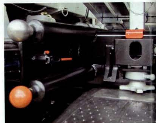
Doppelkopf: Neben den Standard-Kugelpunktaufnahmen unten dienen weitere zur Verriegelung des Kippaufbaus
