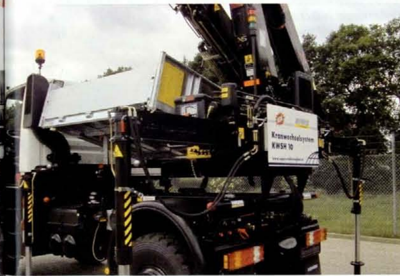
Abgehoben: Das komplette System mit Kran und Kipper wird angehoben...
