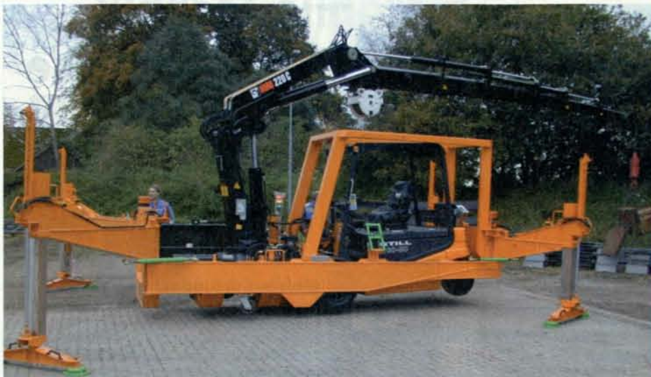
(links) 18,5-tm-Kran in Spezialausführung auf Still-Gabelstapler mit elektronisch überwachter Abstützung. (oben) Kippcontainerchassis mit pneumatischer Heckabstützung (unten) Niederflur-Tiefsattelanhänger für den Transport von Flurförderzeugen
