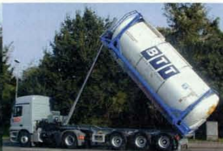
(links) 18,5-tm-Kran in Spezialausführung auf Still-Gabelstapler mit elektronisch überwachter Abstützung. (oben) Kippcontainerchassis mit pneumatischer Heckabstützung (unten) Niederflur-Tiefsattelanhänger für den Transport von Flurförderzeugen
