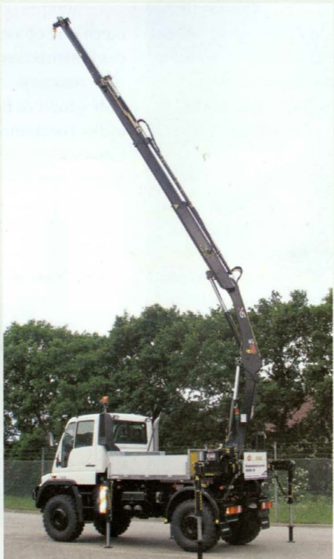
Zusatznutzen durch Wechselkonzept: Eggers-Unimog-Aufbau mit Ladekran.
