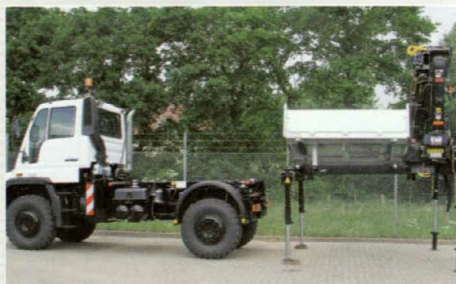
Zusatznutzen durch Wechselkonzept: Eggers-Unimog-Aufbau mit Ladekran.
