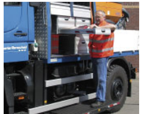
Sicherheitsaspekt: Ausziehbare Trittstufe zwischen den Achsen erleichtert die Arbeit am Werkstattaufbau
